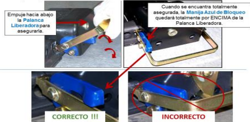
PASO 1 Desenganche: Empuje hacia adentro la Manija Azul de Bloqueo, después jale hacia arriba la Palanca Liberadora. PASO 2 Posicione: Coloque el chock Lo-Pro™ en su lugar. PASO 3 Asegure: Empuje la Palanca Liberadora hacia abajo. Asegure que la Manija Azul de Bloqueo quede por ENCIMA de la Palanca Liberadora.
