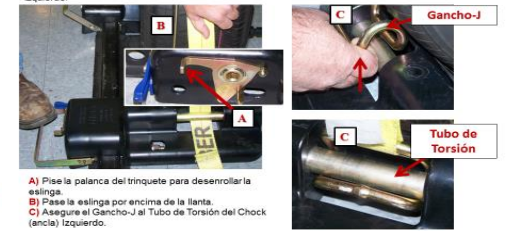
PASO 1 Desenganche: Empuje hacia adentro la Manija Azul de Bloqueo, después jale hacia arriba la Palanca Liberadora. PASO 2 Posicione: Coloque el chock Lo-Pro™ en su lugar. PASO 3 Asegure: Empuje la Palanca Liberadora hacia abajo. Asegure que la Manija Azul de Bloqueo quede por ENCIMA de la Palanca Liberadora.
